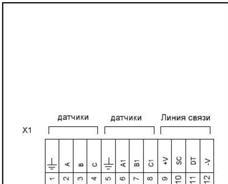
Схема подключения коммутатора СКВН
