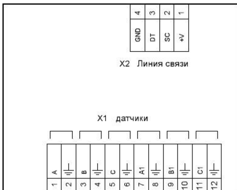
Схема подключения коммутатора СКВН2
